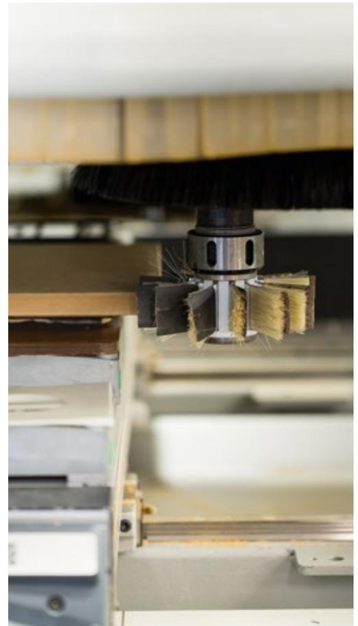
Schleifkopf + Aggregatkopf
